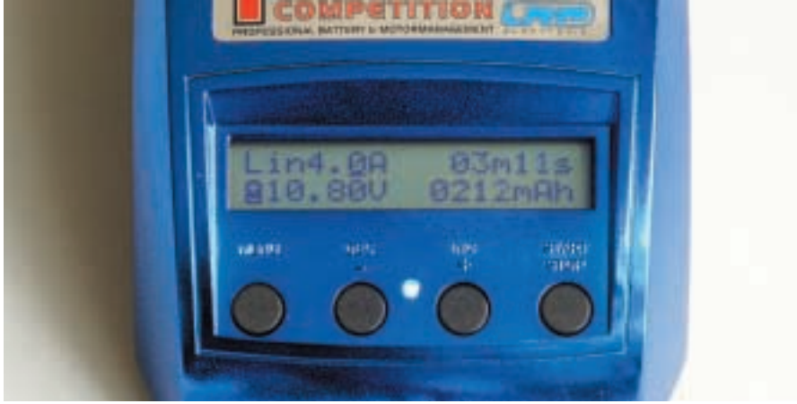
Das Display des Competition. Es bietet auf einen Blick alle wichtigen Informationen über den Ladevorgang
